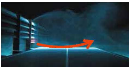
Изучение видимости в условиях аэродинамической трубы (масштаб 1/30)
