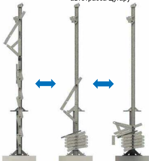
Схема движения блока снегозащитных щитов
