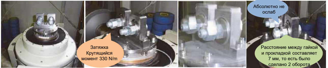
Болт с перекрестной резьбой M24 4,6T (с крючком)
