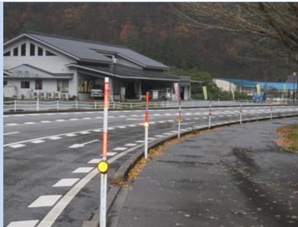
Опоры-стойки из медной трубы (H=2~4м), покрытые лентой из пластика разного цвета (красный, белый и др.). Служат главным образом для обозначения границ дорожного полотна, а также применяются в качестве визуальных ориентиров при уборке снега.
