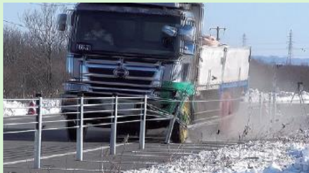
Эксперимент по наезду крупногабаритного грузовика на ограждение
