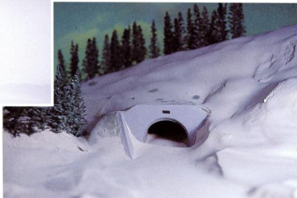
Результат аэродинамического моделирования около входа в туннель
