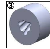
③ По чертежу ② изготавливается вращающийся подвижный орган, которая по форме повторяет одинаковое направление свивки и шаг стального каната.
