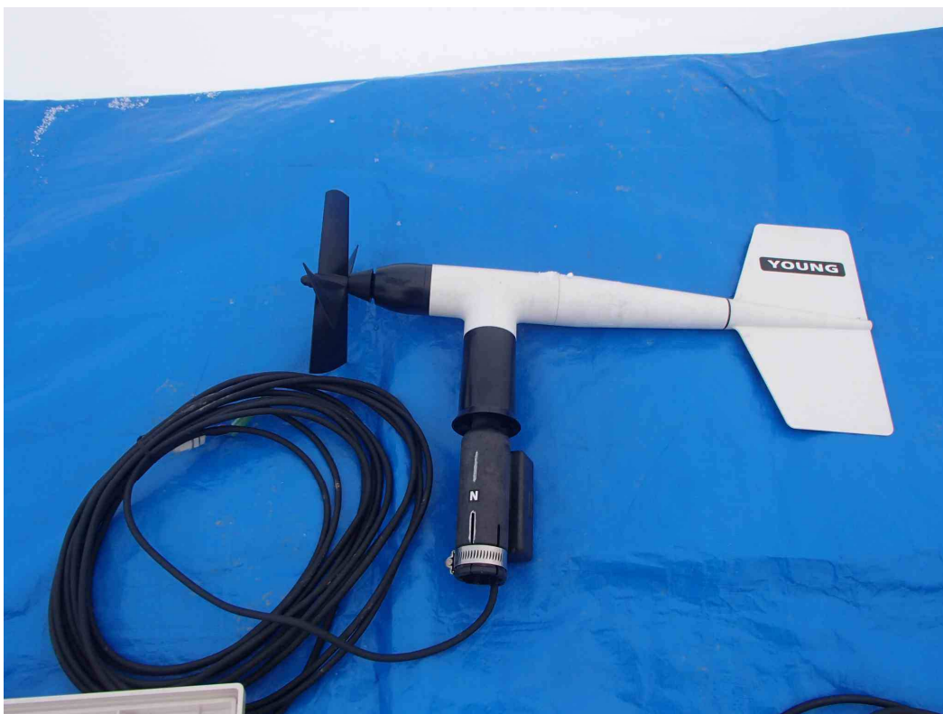
写真 2-2-5 機器検収 (風向風速計)
