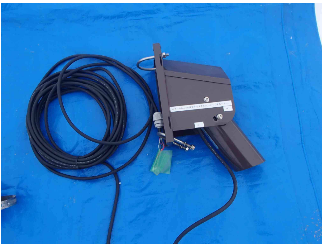
写真 2-2-4 機器検収 (積雪深計)
