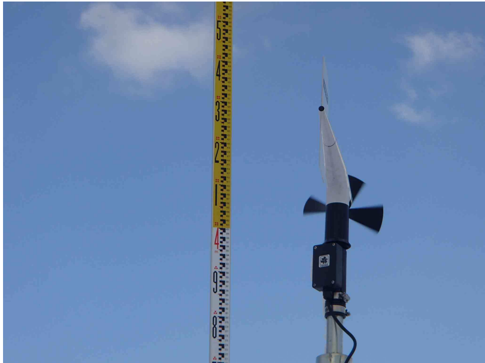
写真 2-3-6 風向風速計 (H=4.0m)
