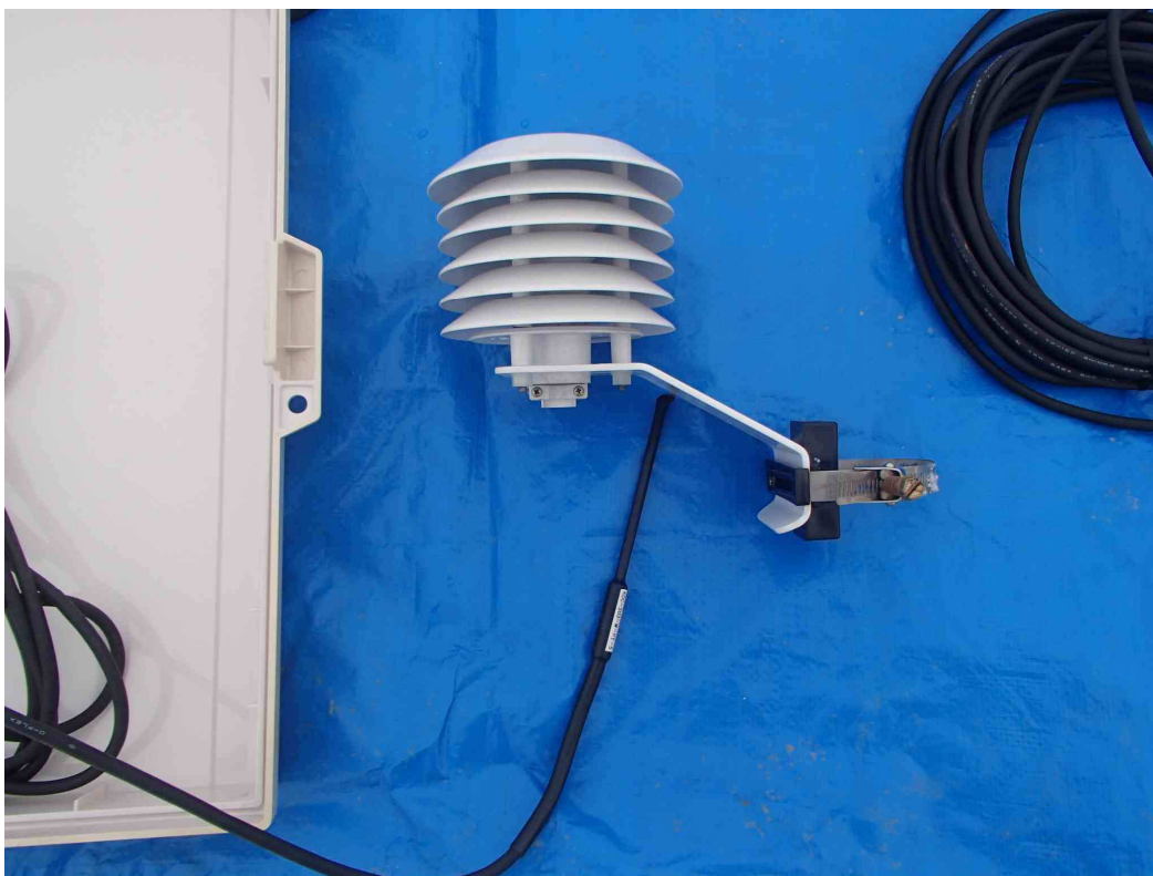
写真 2-2-3 機器検収 (気温計)
