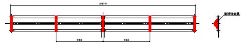
(E) 板補強金具センター1個 + 750mmピッチ + 両端各1個 計5個
