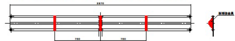
(D) 板補強金具センター1個 + 750mmピッチ 両端各なし 計3個
