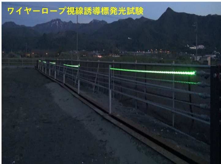
ガードレール視線誘導標発光試験
