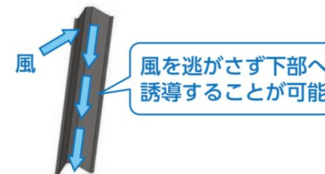
2 下部間隙閉塞時に柵風上側に雪を溜めるため、道路上に吹き溜まりを生じさせません。
