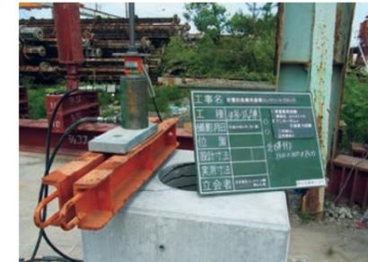
アンカーボルト引抜耐力試験
