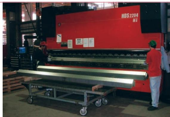
製造は、切断加工、孔あけ加工、曲げ加工、仮組立、溶接までを一ラインとして行っています。鋼材検査、めっき付着量試験、製品検査を経て、高品質な製品を提供しています。
