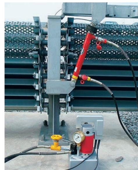
弊社および他社製品の既設防雪柵【各種折畳式下部収納型】に自動建込・収納装置取付金具を取付け、自動で建込み・展開作業および収納作業を行うことができる工法です。
