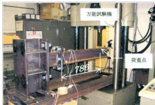
鋼材曲げ試験
