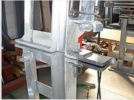
折畳式下部収納型防雪柵の維持管理業務において防雪柵の建込み作業・収納作業に電動油圧装置及び電動ウインチを使用し自動で行います。防雪柵維持管理業務による建込み作業・収納作業時に使用でき、離れた位置からの遠隔操作が可能です。
