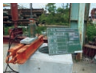
アンカーボルト引抜耐力試験
