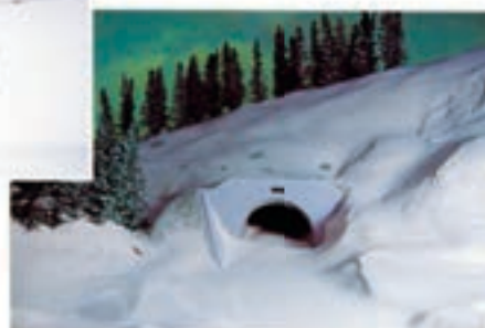
坑口付近の風洞実験結果
