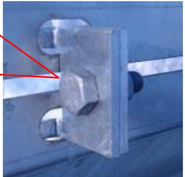
従来、防雪板の連結作業は作業員二人で防雪板を挟み両側（風上側・風下側）に分かれて施工しています。その為、現場によっては風上側の足場が不安定であり、必要に応じて足場の設置や高所作業車等を使用し、対応しています。本技術は、製品自体が防雪板を連結する役割をした形状であり、片側からボルト固定が可能な為、作業員一人で片側から安全に施工が行える巾止金具を提供します。
