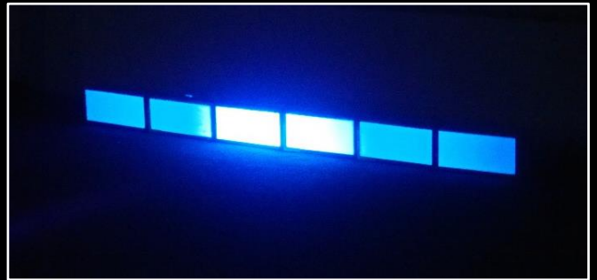
コンクリートブロックに塗料を塗布してブラックライトを照射した状況
