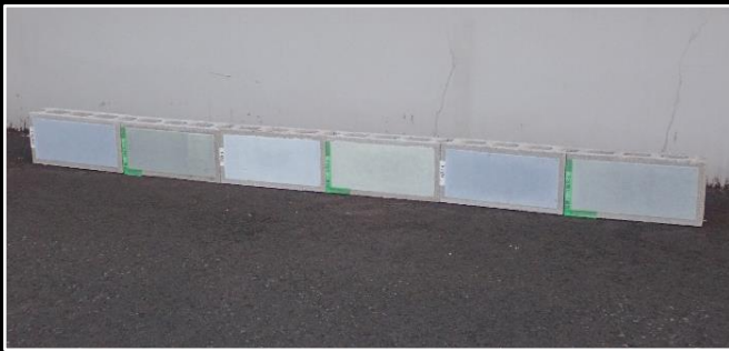
コンクリートブロックに塗料を塗布してブラックライトを照射した状況
