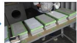
下地処理 (プライマー塗布)
