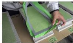
型枠・マスキング撤去
