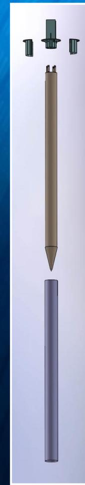
Pengembangan metode pemasangan heat exchanger menggunakan pile pencegah masuknya tanah ke dalam pipa pancang baja
