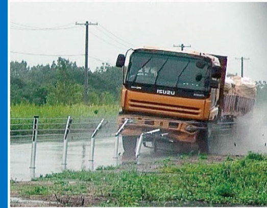
写真-4 大型貨物車による衝突実験の状況
