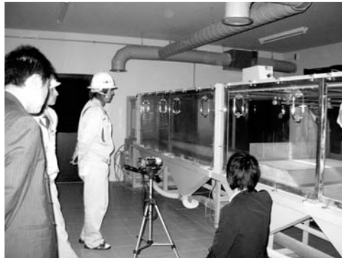
風洞実験装置により地吹雪の状況を再現
