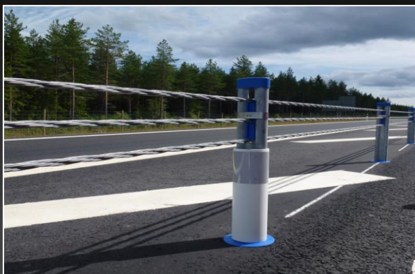
海外高速道路 路肩用ワイヤーロープ式防護柵として。
